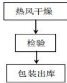
图 3.1.2-2 不锈钢管生产工艺
